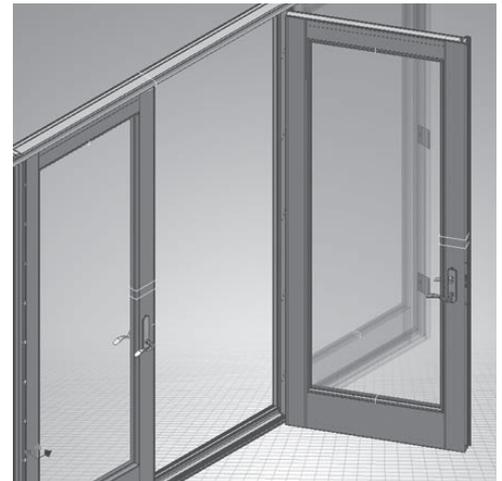
**18.** Mientras esté manobrando el panel de la puerta para ponerlo en su lugar, compruebe que el borde de la bisagra se acople totalmente con al marco antes de instalar los tornillos de ensamblaje #12 x 3/4" (Ver la siguiente sección de diagrama para mayor detalle).
